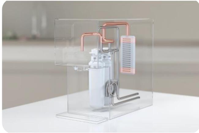
물을 저장해 두고 사용하지 않는 동안에도 가열과 냉각을 반복하는 저수조 방식이 아닌 냉/온수 탱크 및 저수조를 제거하여 필요한 순간에만 순간냉각, 순간가열하는 All 직수 시스템 적용
