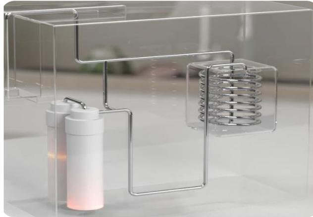
세균 번식이 쉬운 플라스틱 유로를 1년마다 교체해주던 방식에서 벗어나 부식 및 세균 등의 오염 걱정이 없는 스테인리스 유로를 적용하고 화학 약품이 아닌 고온 살균으로 위생성 확보 및 플라스틱 유로 폐기물 발생 제거
